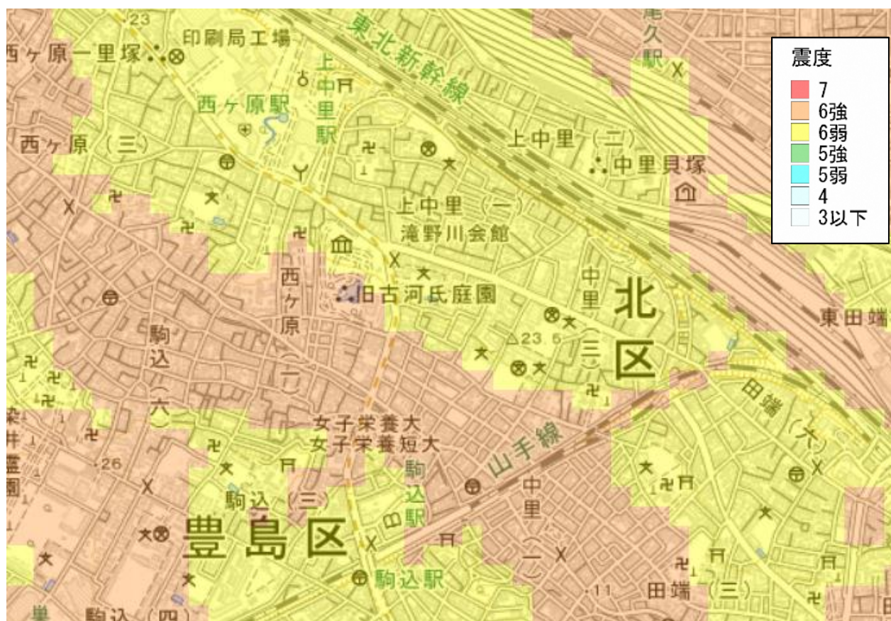
北区全域で想定される被害 都心南部直下地震（M7.3）
