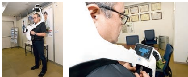
▲ ウェアラブル型計測デバイスを身につけ歩きながら3Dスキャン。短時間で広範囲の空間情報を取得できる
