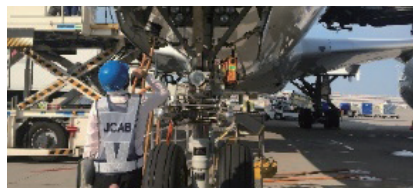
機体の胴体・主翼(エンジン含む)・脚などに部品欠落・着氷等がないか点検
