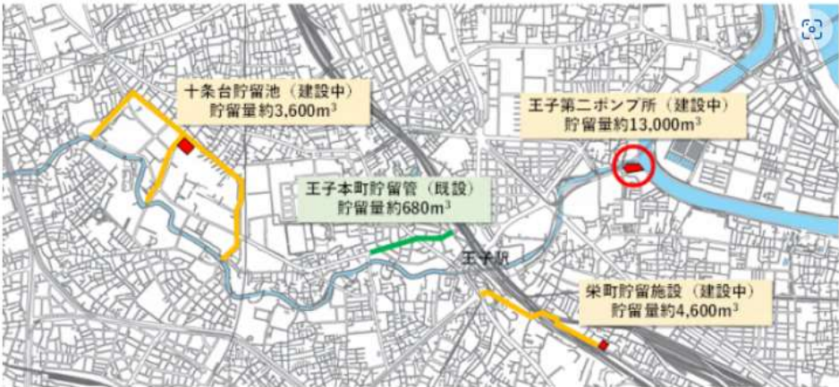
貯留施設の整備状況
