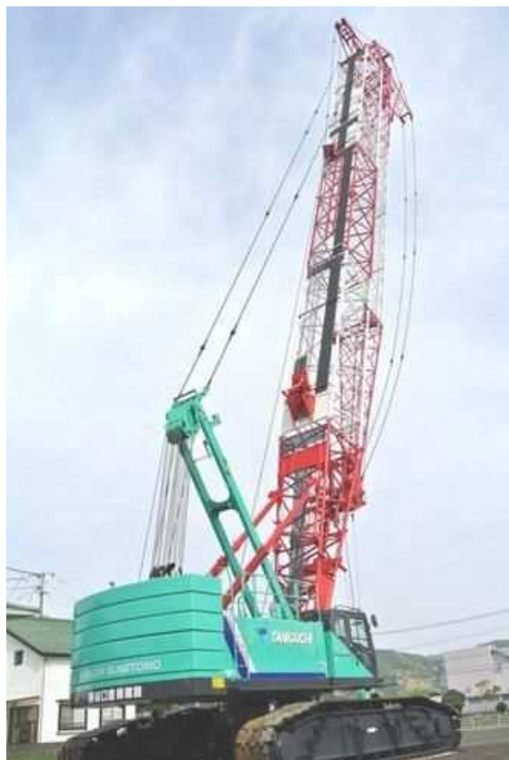
クローラクレーン
